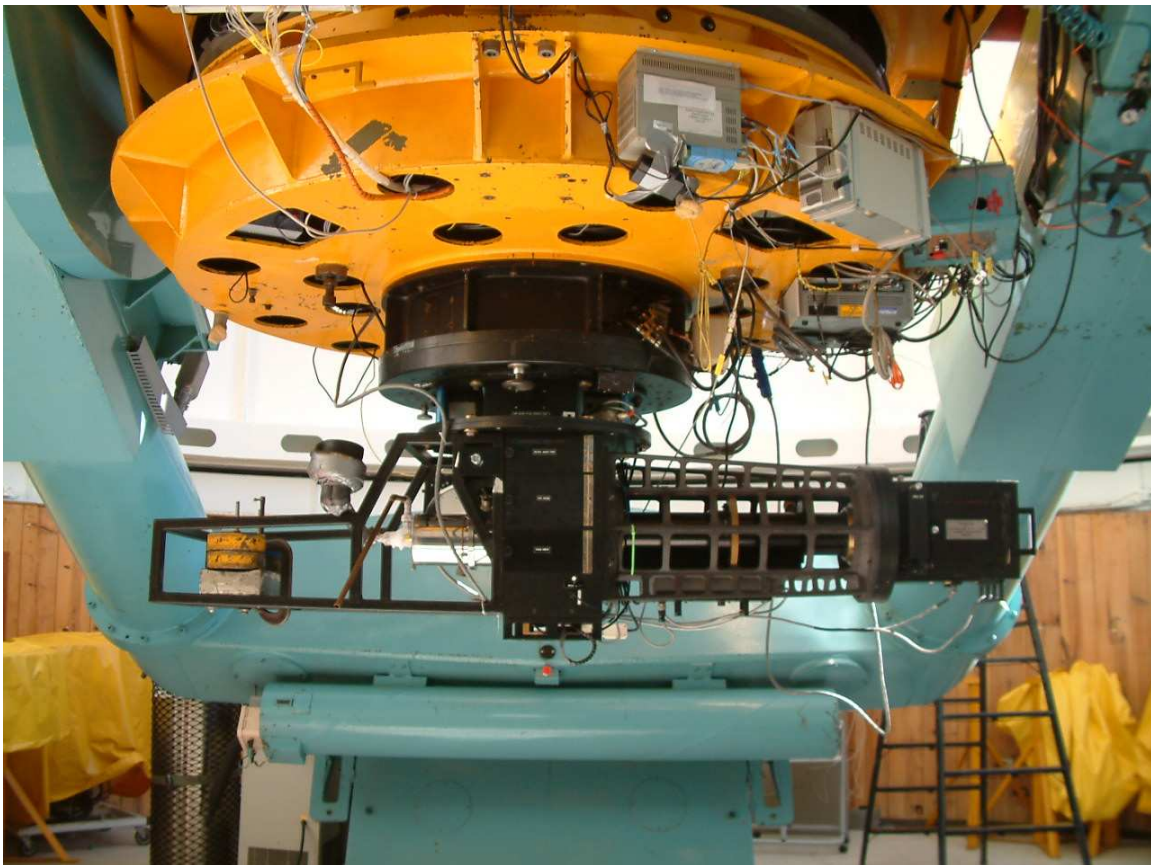
Figura 2c. Mezcal con contrapeso instalado. Instalación actual por omisión. Orientación instrumento E – W, rendija N – S.
