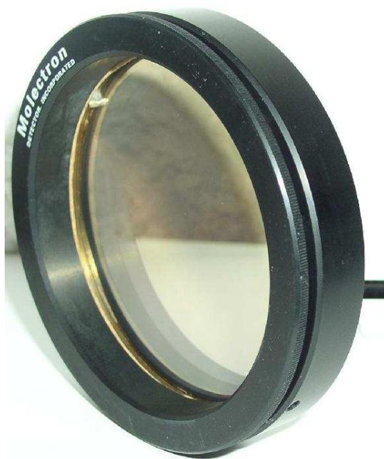
FIGURA 8.3: Fotografía del polarizador que se instala en CAMILA-CAMALEÓN. El lado que se muestra en esta figura es el que debe quedar hacia arriba.
