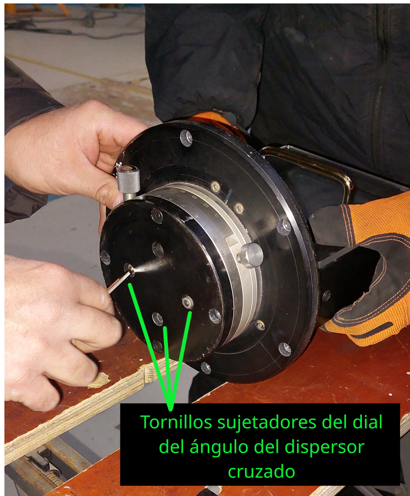
Figura 6. Ubicación de los tres tornillos que unen el dial de ángulo y el dispersor cruzado.
