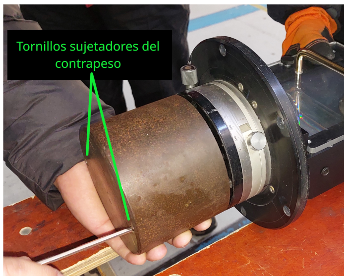
Figura 5. Izquierda: Ubicación de los dos tornillos que unen al contrapeso con el dispensor cruzado. Derecha: Contrapeso una vez separado del dispensor cruzado.
