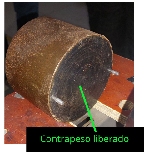
Figura 5. Izquierda: Ubicación de los dos tornillos que unen al contrapeso con el dispensor cruzado. Derecha: Contrapeso una vez separado del dispensor cruzado.
