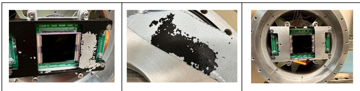
**Figura 9.** Detalle de la pintura arrancada del marco de soporte del CCD. Esta operación requirió varios intentos cambiando en cada iteración la cinta usada por cinta nueva.
