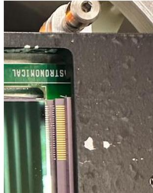
**Figura 8.** Detalle de la pintura que se estaba desprendiendo del marco de soporte del CCD.
