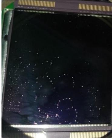
**Figura 1:** CCD Marconi 5 antes del procedimiento de limpieza. A la izquierda se pueden ver los patrones de gotas sobre el CCD.
