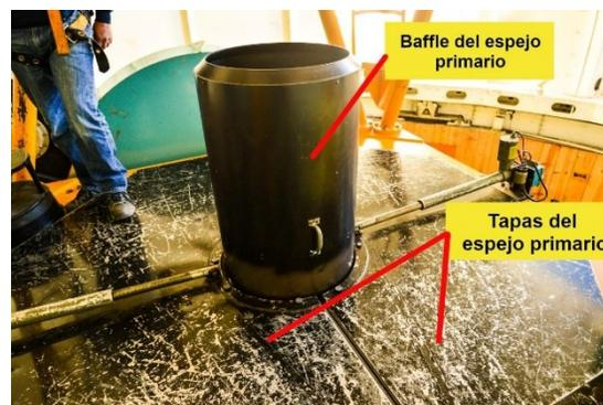
*Figura 3: Tapas del espejo primario en posición cerrada.*
