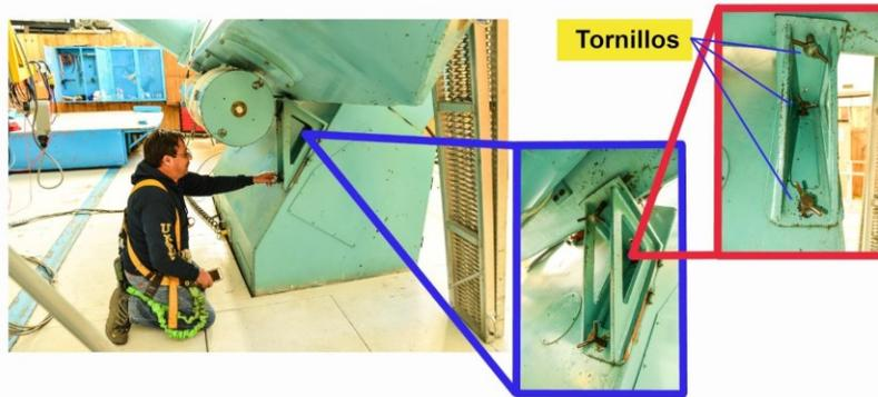
**Figura 8:** Ancla para fijar el telescopio en dirección de Ascensión Recta (AR) y posición de los tres tornillos para fijarlo.
