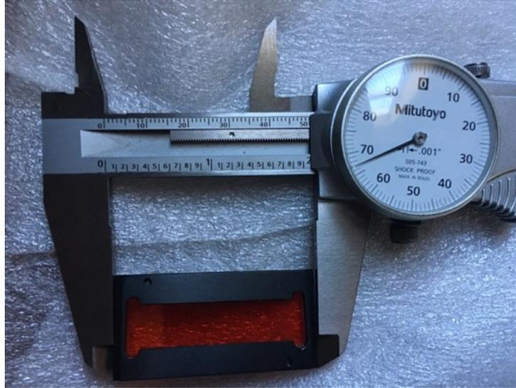
**Figura 1:** Filtro de SCHOTT red-cutter OG550 en su montura de aluminio, este filtro se monta en la bayoneta de filtros del Boller.
