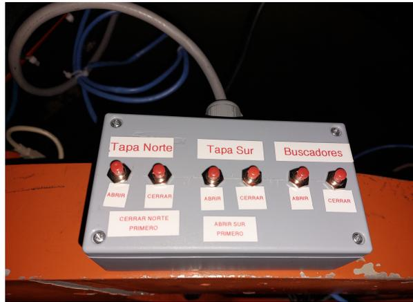
Figure 2: Botonera para abrir las tapas del espejo primario y buscador (al Norte).
