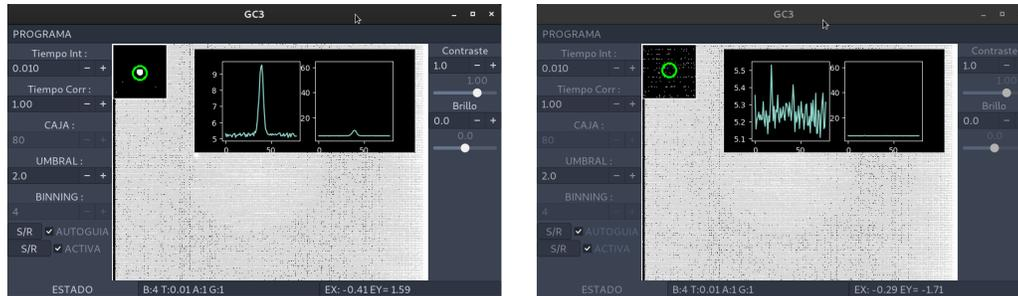
Figure 6: Al iniciar el guiado, este se pierde y mueve el telescopio hacia el Norte.
