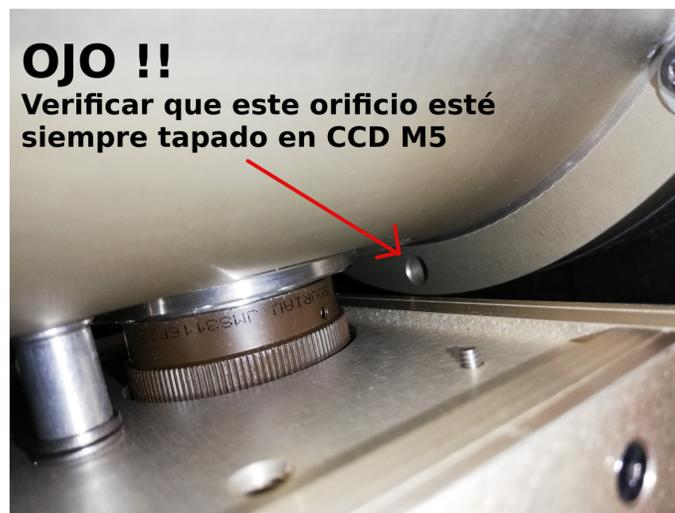
Figure 2: Orificio por donde se filtraba luz al CCD M5.
