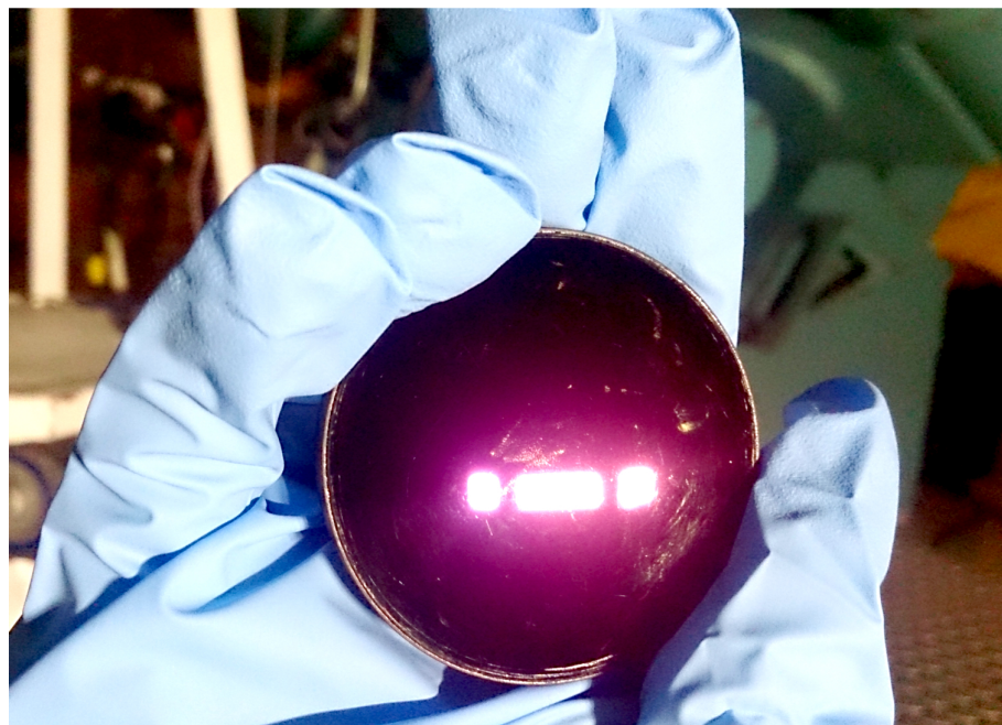
Figure 3: Filtro u de Stromgren donde se muestra suciedad en una de las caras. Esta suciedad no fue posible removerla con líquido para limpiar superficies ópticas.
