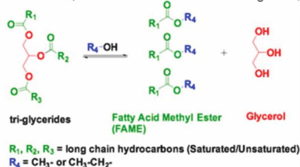
Esquema 1. Producción de biodiésel: transesterificación de los tri-glicéridos.
