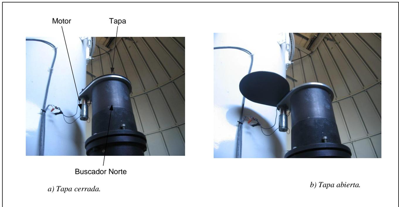
**Figura 15:** Tapa del buscador Norte del telescopio de 84cm.
