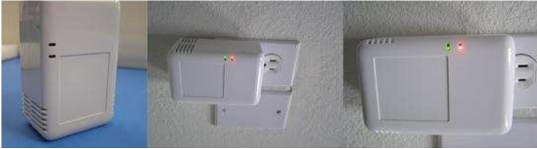
Figura 3: Imágenes de la PC “SheevaPlug”. Esta PC se conecta directamente a un tomacorriente eléctrico de 115 VAC.
