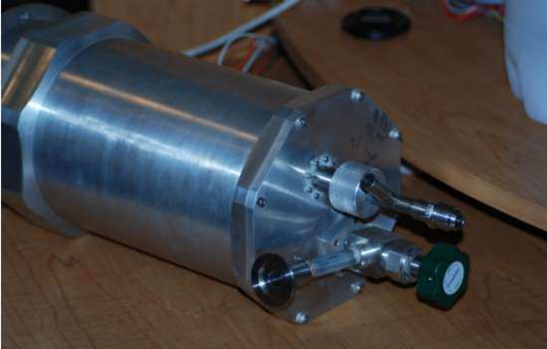
Fig. 3. Fotografía de la botella Criogénica ya construida.
