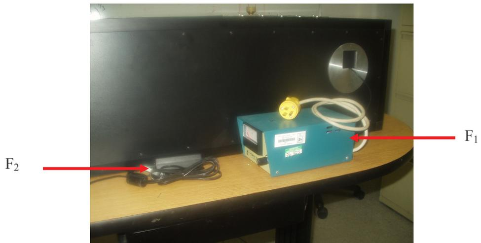
Figura 2.- Fuentes de alimentación de las lámparas de Cobre-Argón ( $F_1$ ) y Halógeno ( $F_2$ ).
