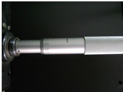
Figura 10.- Desplazador micrométrico, usado para inclinar la rejilla de difracción y poder seleccionar la ventana espectral deseada.
