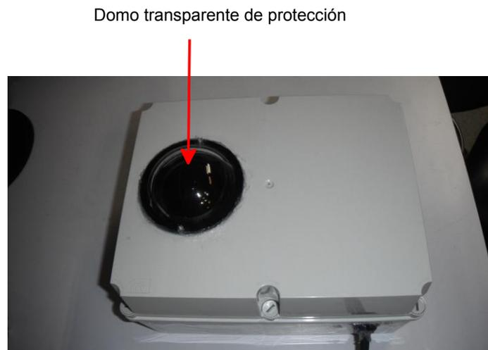
**Figura 3:** Vista de la tapa del gabinete con el domo de protección.
