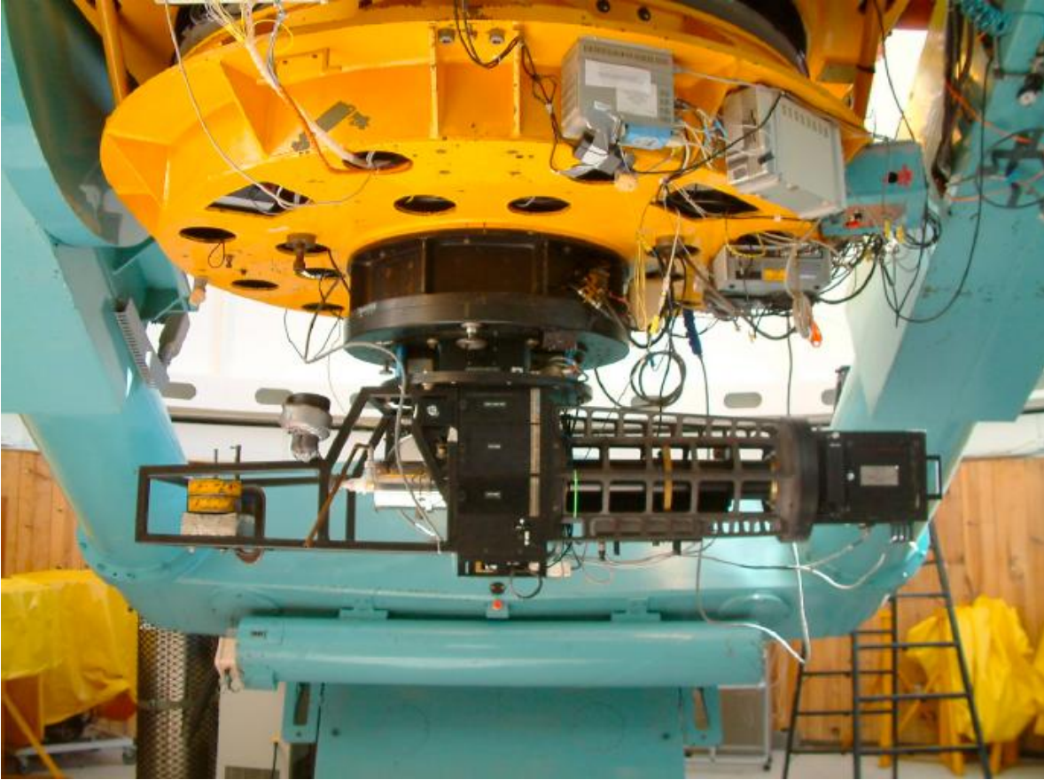
Figura 2: Fotografía de Mezcal en su posición por omisión ( PL=0^\circ ). Nótese que a pesar de que la rendija está orientada Norte-Sur, el instrumento está orientado en el eje Este-Oeste, con el cuerpo del instrumento hacia el Oeste y el contrapeso hacia el Este. Fotografía tomada de López et al. (2010).
