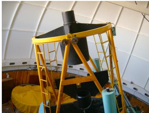
**Figura 1: Pesas en la estructura del secundario en el Telescopio de 2.1-m.**
