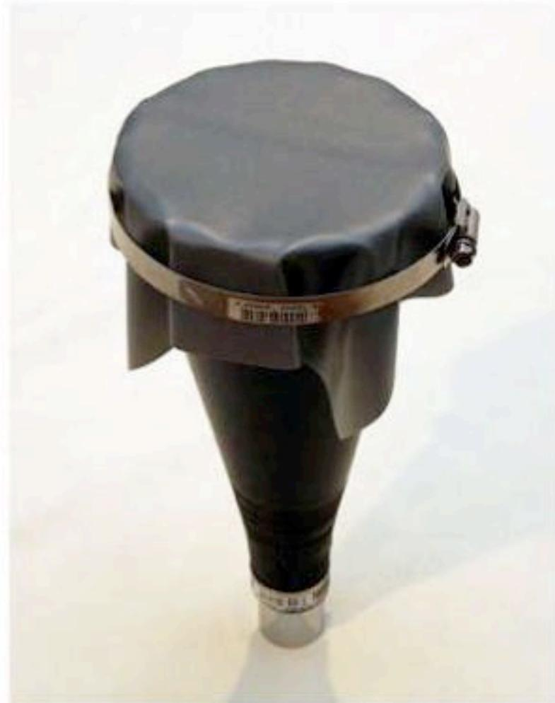
. . . Y utilizando el desarmador, apriételo alrededor del embudo para asegurar firmemente la pantalla; cuando la abrazadera comience a apretar, jale y acomode con cuidado los lados sueltos del material, de modo que la pantalla quede plana y estirada sobre la abertura del embudo. Este es un proceso interactivo en el cual se requiere estirar la pantalla y atornillar la abrazadera.
