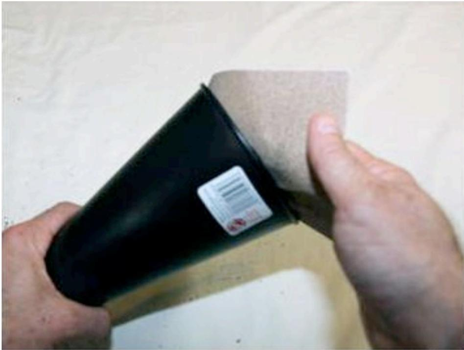
Paso 5.- Utilizando la lija de arena, pule los cortes hechos en ambos extremos del embudo
