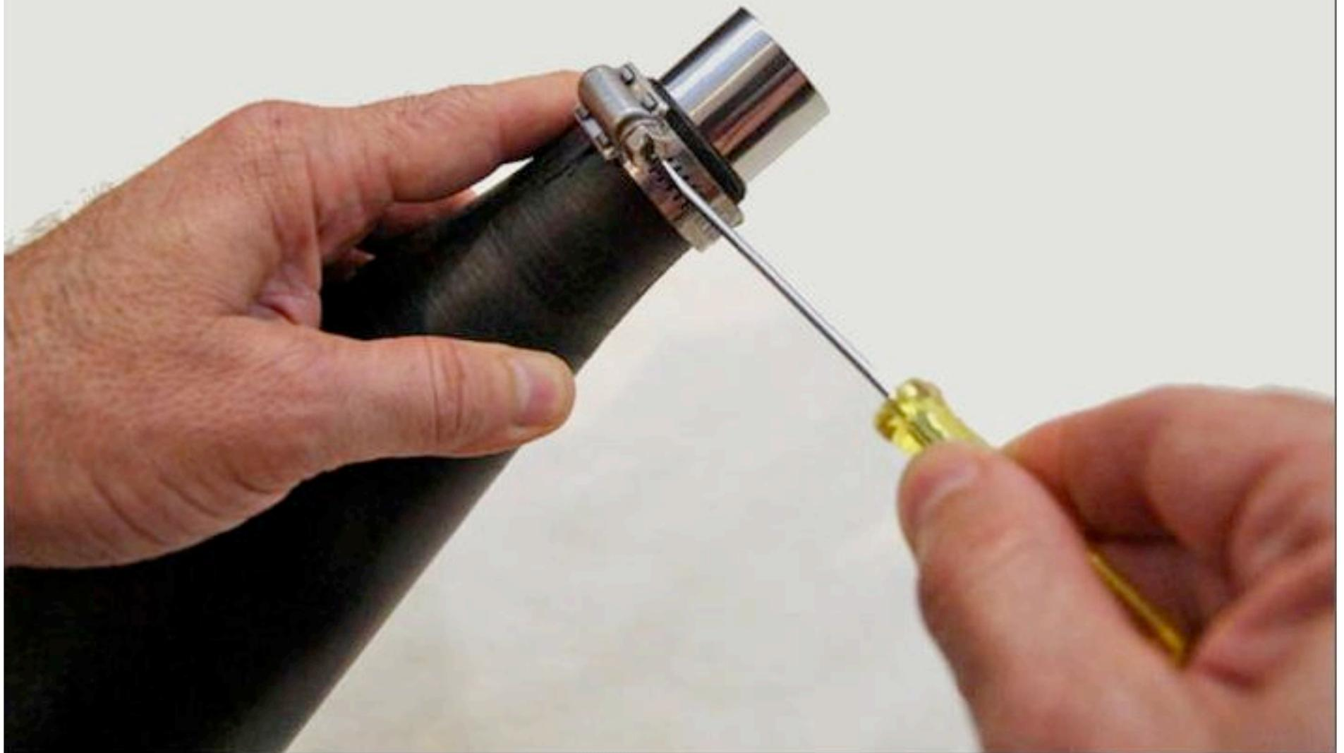
Paso 9.- Gire el lado ancho del embudo hacia arriba (quizás sea mas fácil sostenerlo entre las rodillas). Coloque la pantalla Da-Tex sobre el lado ancho de la abertura, sin importar cual lado apunta hacia arriba. Deslice la abrazadera grande sobre el lado ancho del embudo . . .
