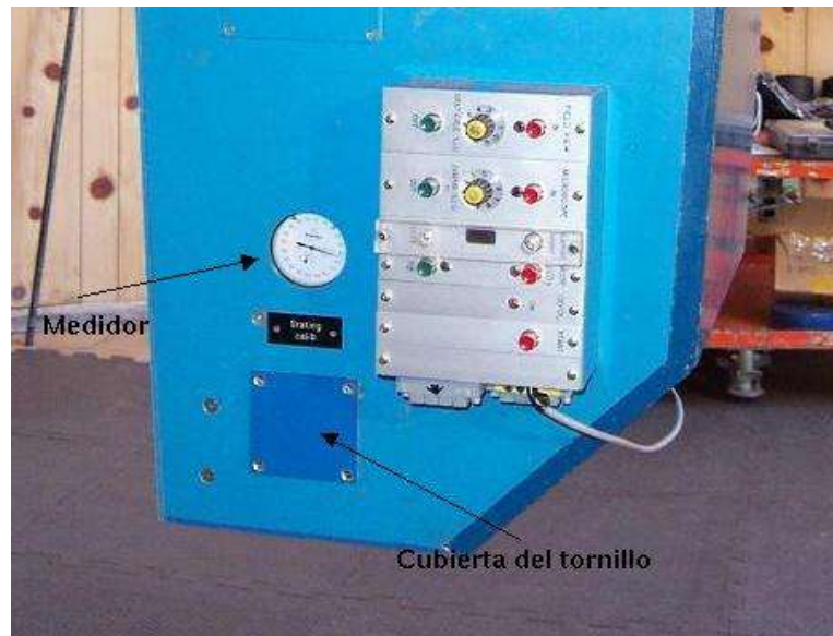
Figura 10. Fotografía del fotómetro donde se muestra la tapa que cubre la perilla del tornillo así como la carátula del medidor
