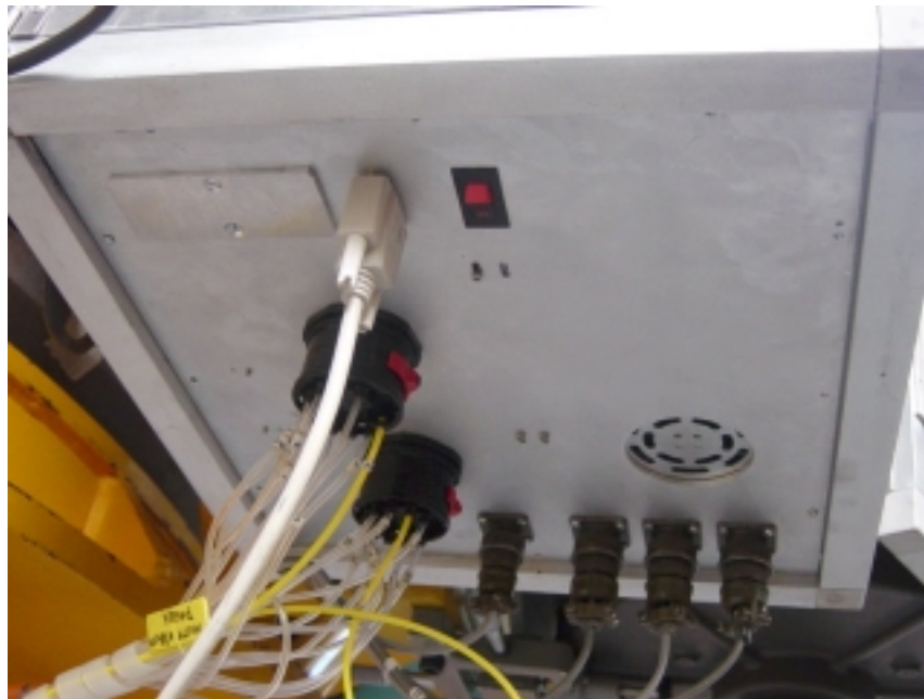
Figura 12. Conectores ubicados en la parte inferior de la caja de control.
