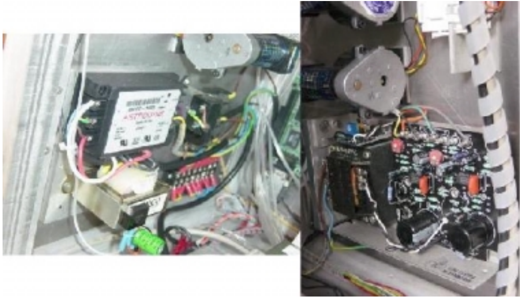
Figura 9. Fuentes de alimentación que suministran los voltajes requeridos por el sistema.
