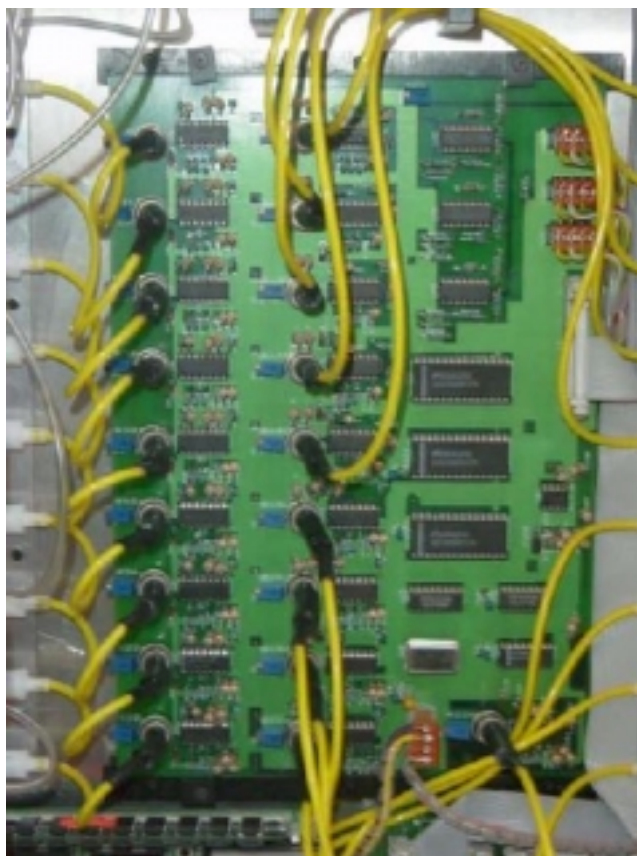
Figura 3. Tarjeta electrónica con 19 sensores de presión y los convertidores analógico a digital.
