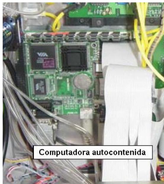
Figura 2. Microcomputadora encargada del control del sistema.
