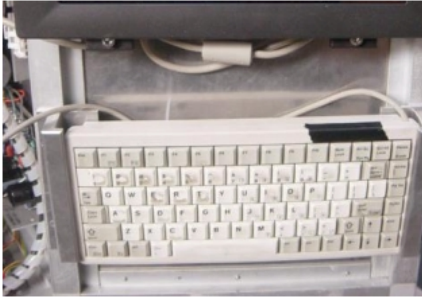
Figura 11. Teclado miniatura colocado en la tapa de la caja de control.
