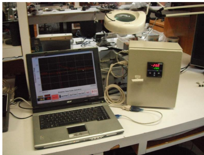
Figura 8: Pruebas en el laboratorio del sistema controlador de temperatura mostrado a la derecha de esta fotografía.
