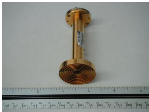
Figura 3: Antena alimentadora para el amplificador de bajo ruido.
