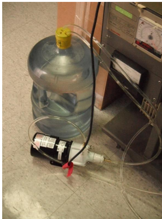
Figura 14: Pruebas del sistema circulador en el laboratorio. En esa ocasión se utilizó agua como líquido refrigerante. En la fotografía se puede apreciar la bomba de vacío utilizada en las pruebas.
