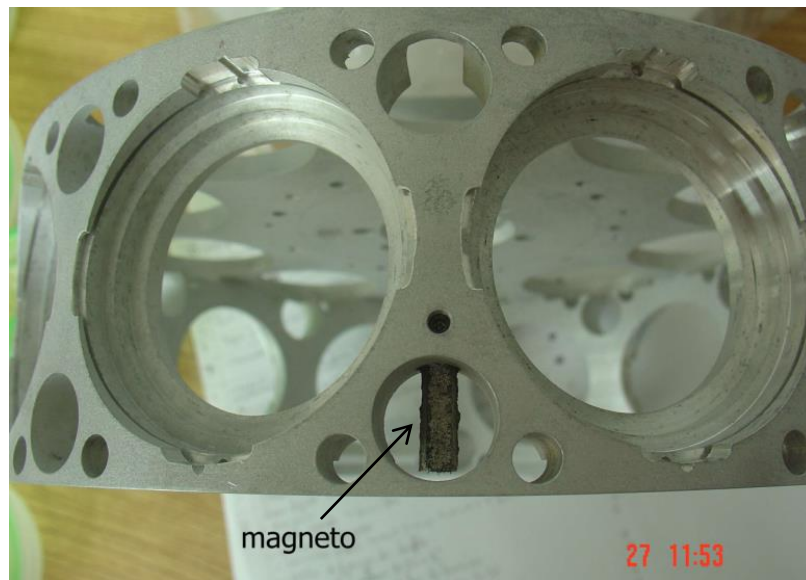
Figura 24: Vista de magneto insertado en el carrusel.
