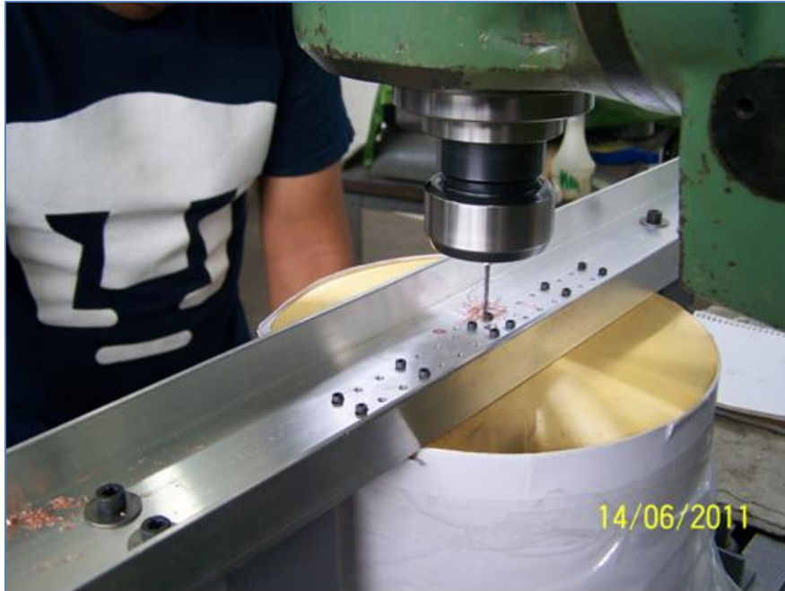
Figura 9: Proceso de barrenado en la superficie de trabajo del criostato.
