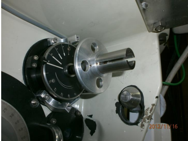
Figura 2: Foto y dibujo de la parte giratoria montada sobre la perilla del micrómetro de la rendija del espectrógrafo Boller & Chivens.
