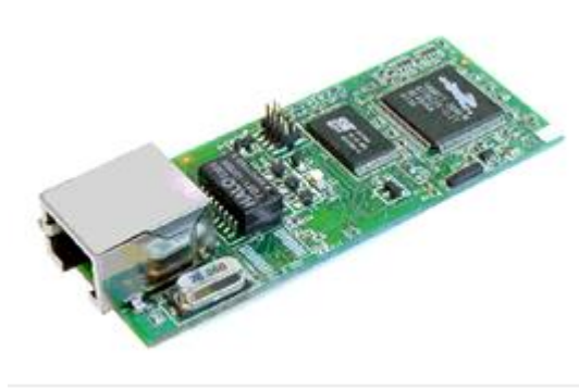
Figura 6: Microcontrolador RabbitCore RCM3700 (foto de hoja de datos Rabbit Core RCM3700) [2].
