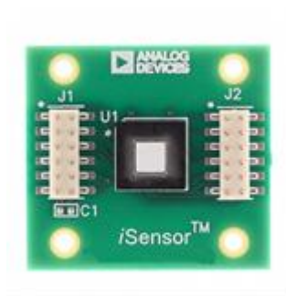
Figura 2: Inclinómetro y acelerómetro ADIS 16209, foto Analog Device [1].
