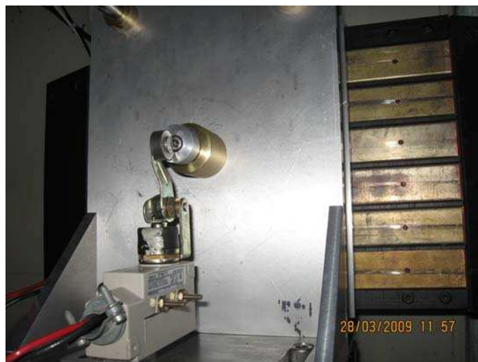
Figura 7. Interruptor de cúpula en posición.
