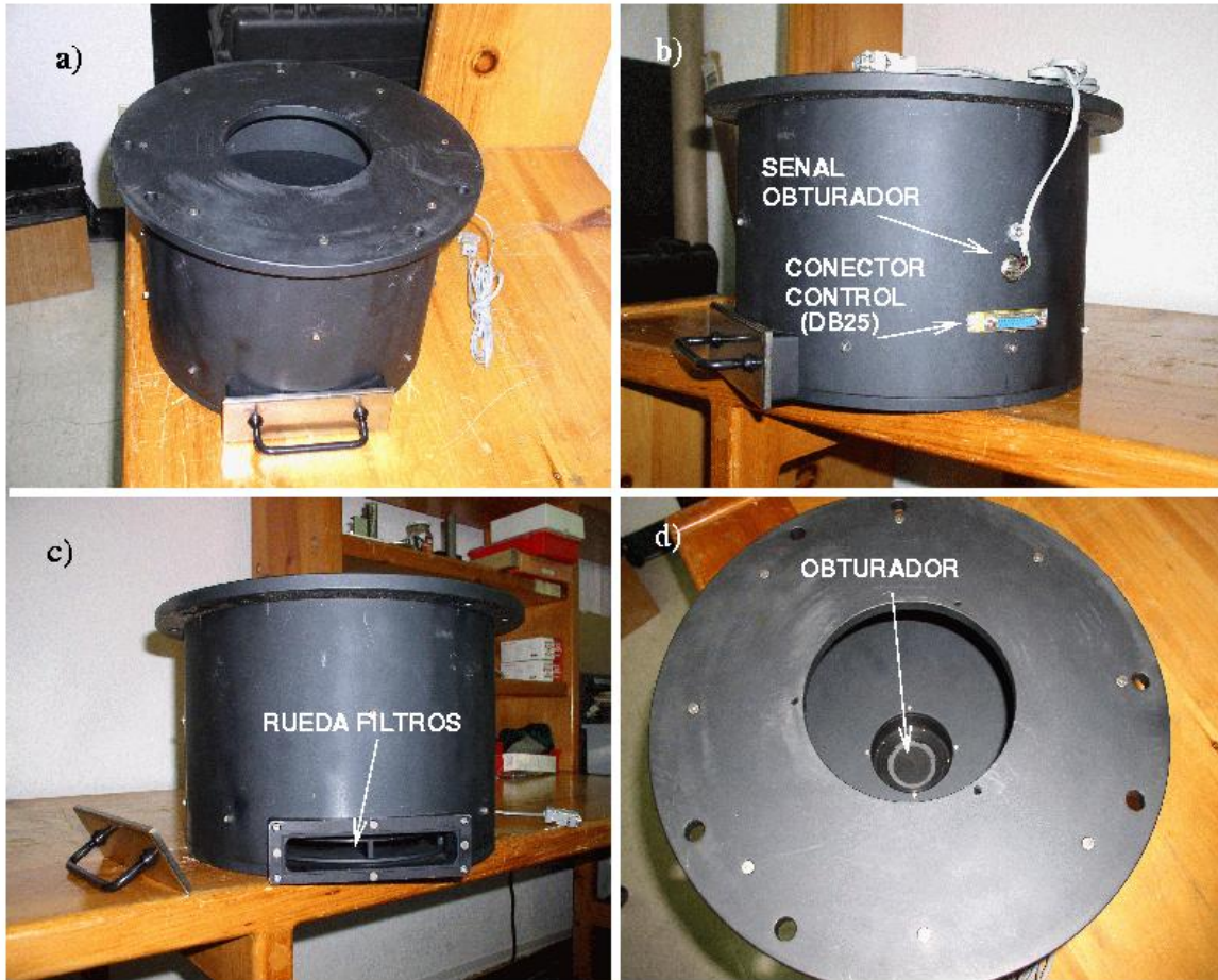
Figura 10. Cabezal de POLIMA. a) Vista lateral. b) Entrada de señales eléctricas al cabezal. c) Acceso a la rueda de filtros. d) Vista superior.
