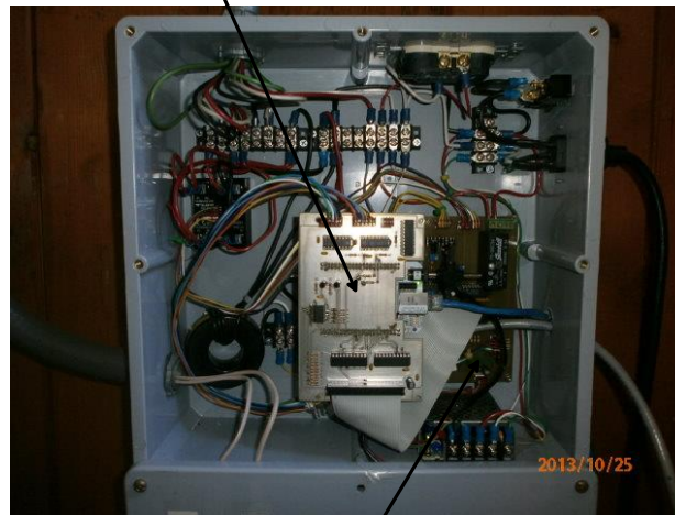
Tarjeta de relevadores y sensores de cortina y gajo
