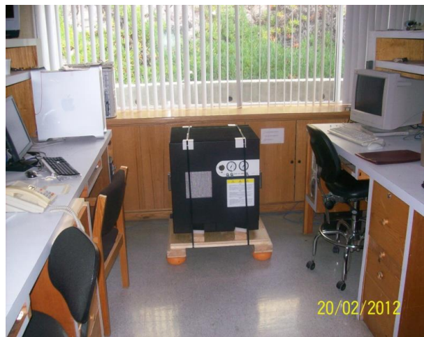
Figura 1: El gabinete contiene el compresor y la fuente de alimentación de la Cámara CCD.
