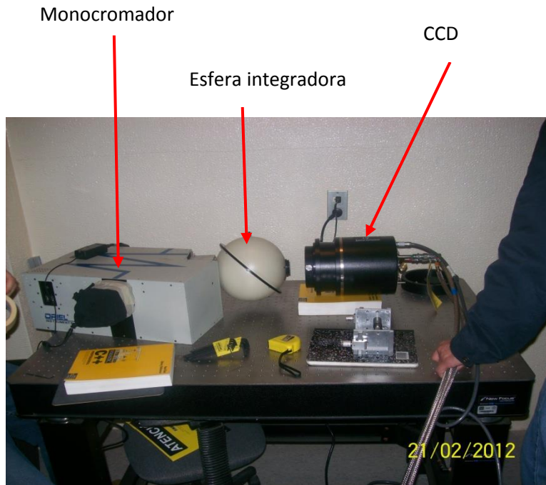
Figura 2: Instalación de la cámara a la fuente de luz monocromática.
