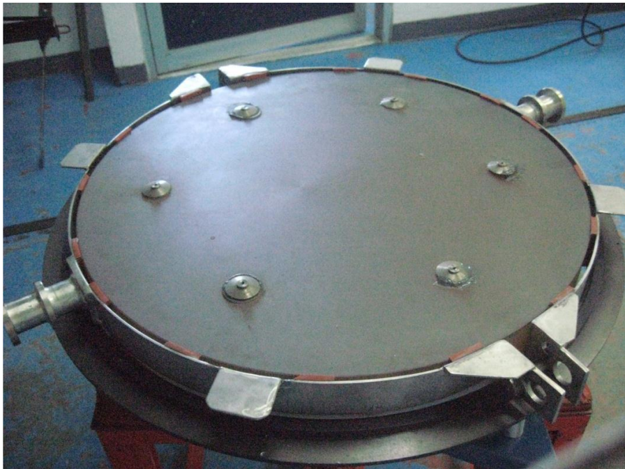
Figura 1: Vista de la parte trasera del Secundario F/7.5 con los discos metálicos pegados.
