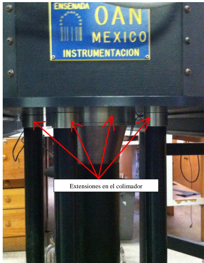
Figura 8: Detalle de las extensiones de metal colocadas al colimador para igualar los focos.
