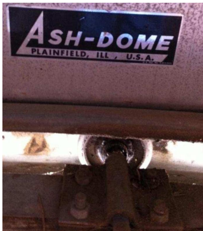
Figura 12: Marca del domo y vista de uno de sus rodamientos.
