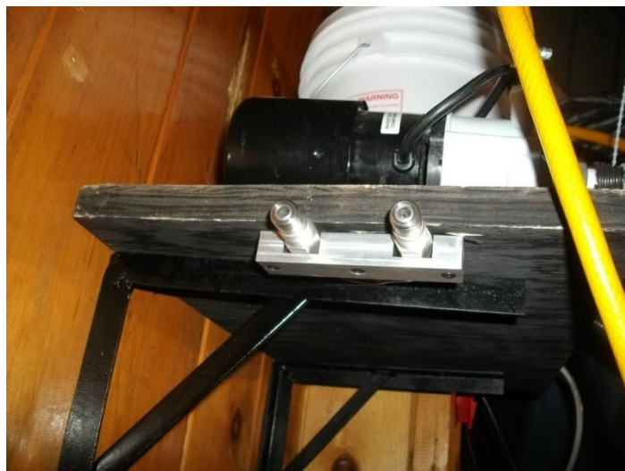
Figura 4: Conectores debajo de la bomba de circulación. Las mangueras deberán conectarse a éstos cuando se retiran de la cámara.
