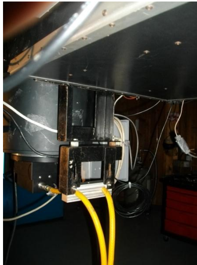
Figura 3: Manera de sujetar las mangueras al soporte de platina.
