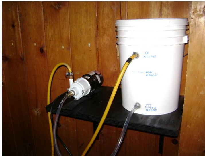
Figura 1: Cubeta y bomba de circulación para el enfriamiento por líquido de la cámara FLI.
