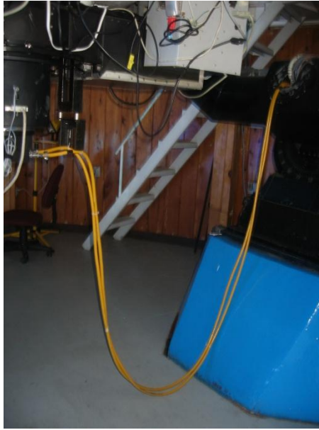
Figura 2: Manera de sujetar las mangueras de la cámara FLI en el telescopio de 84cm del OAN para evitar esfuerzos en los conectores. Nótese la longitud de la manguera después de salir del hueco del eje de AR.
