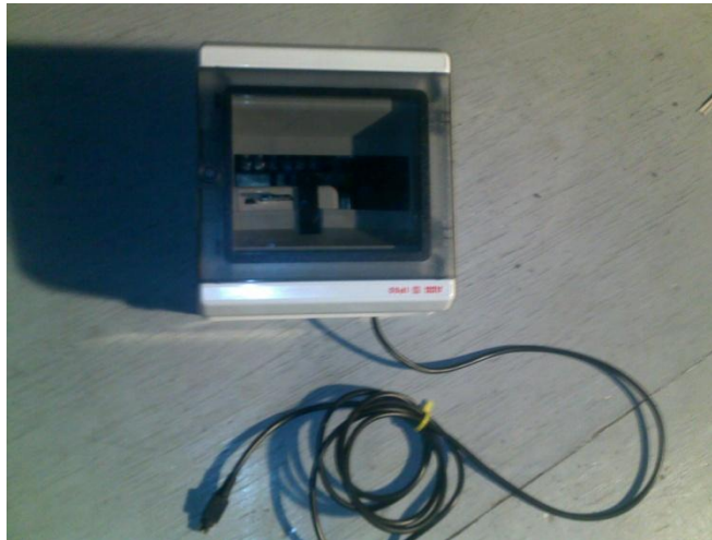
Figura 6: Caja que contienen la fuente de alimentación y computadora de interfaz “Sheeva Plug” para la cámara FLI. Se muestra el cable de alimentación de la cámara FLI.
