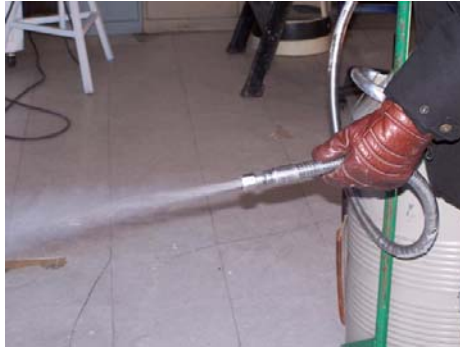
Figura 7.-Enfriando la manguera de transferencia.
