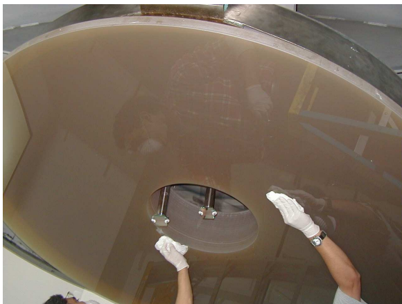
Ultima limpieza antes del aluminizado
